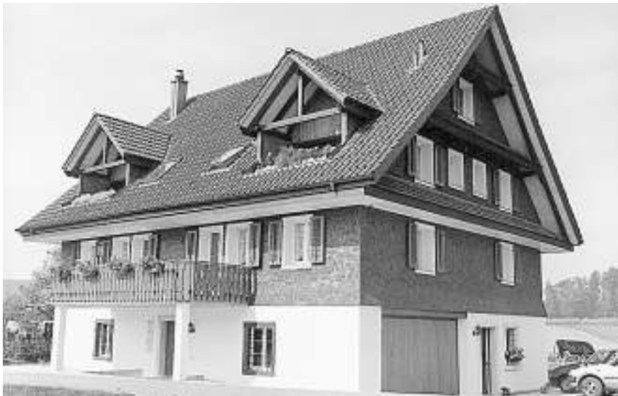
Haus in Niederglatt Rundschindeln 60 mm, 30 mm Fachweite Alle Abschlüsse mit Schindeln ausgeführt; wo möglich, wurde mit Elementen gearbeitet
