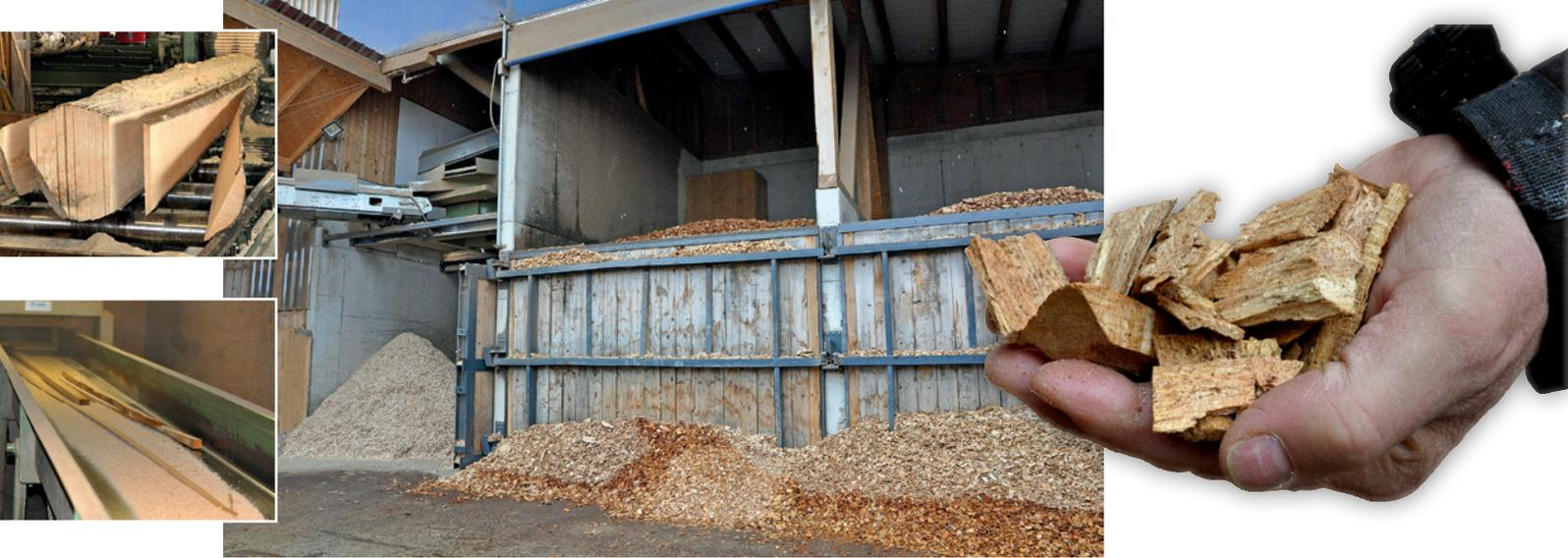
■ Aus den Resthölzern beim Aufsägen der Stämme und beim Zerschneiden der Latten und Bretter (kleine Bilder) werden Hackschnitzel. Sie werden in die Größen G15 und G30 gesiebt. Die größeren sind dem Holzvergaser vorbehalten, die kleineren gehen nur im Sommer in den Vergaser, sonst in die Feuerung.
