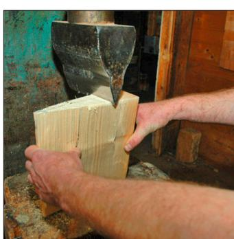
**Nach dem Entfernen der Rinde werden die Stücke in die gewünschte Breite gespalten.**
