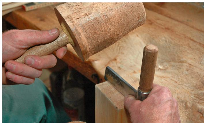
**Das Messer wird angesetzt, mit dem Hammer ins Holz getrieben... (Bilder: Anita Neuenschwander)**
