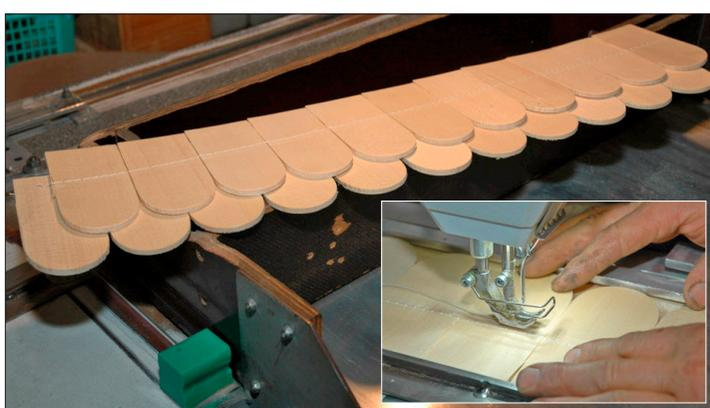
**Um die Effizienz bei der Fassadenmontage zu steigern, werden die Schindeln zu grösseren Elementen zusammengenäht.**
