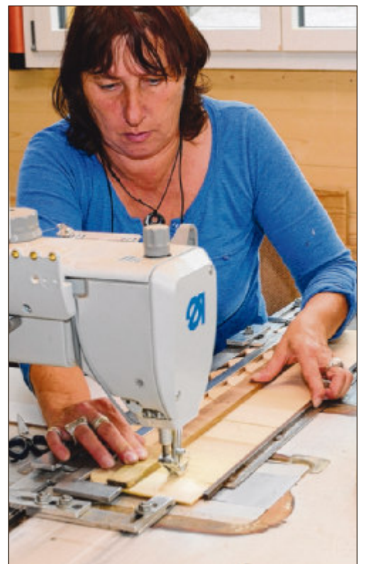
An der Nähmaschine werden einzelne Schindeln zu Elementen zusammengenäht.
