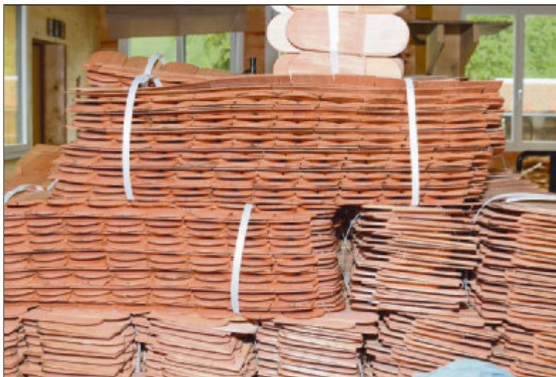
Die Elemente aus Rundschindeln sind an der Fassade schnell montiert.
