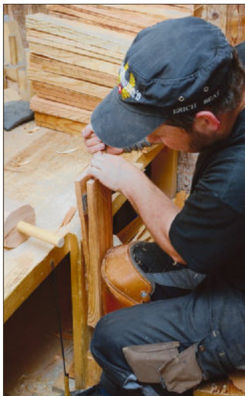
Mit einem Hammerschlag auf das Messer wird das Scheit zu Schindeln gespalten.
